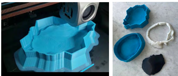
Рис. 3. Печать на 3D-принтере (слева), готовые элементы (справа): синие чаши для заливки силикона, макет имплантата – черный, часть черепа с дефектом – белый
