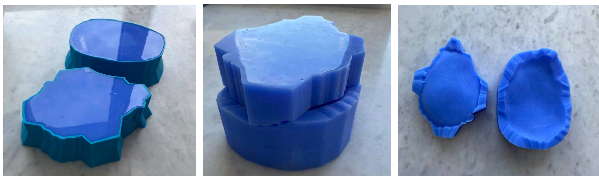
Рис. 4. Этапы создания пресс-форм из медицинского силикона
