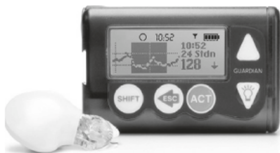
Рис. 4. Система непрерывного мониторинга гликемии в режиме реального времени (Guardian Real-Time)
